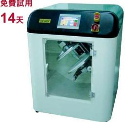
除與上述功能外,這台還【沒有容器限制】,可依容器需求,客製專用容器治具。不管是玻璃 瓶、油墨罐、金屬桶、塑膠、還是軟管容器,都沒有問題,可更換容器治具,一機多用途,不 用換容器。大小罐容量可設定不同配方,記憶達 20 組,油墨攪拌機有運轉參數 6 段執行序設 定,每段均可獨立設定。
